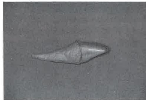
図15 新たに作製したメタルコアにアルミナサンドブラスト処理とSn電析処理を施す
