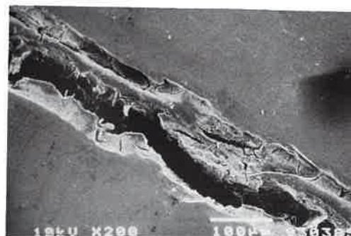
図39 象牙質側に接着性レジンが残り、レジンが凝集破壊を起こしている
