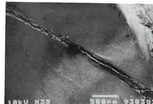
図38 接着部の走査電顕像であるが、破折部の露出レジン層は約0.1mm
